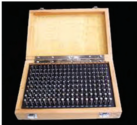
شکل ۵۴ - گیج پین و روش کنترل
